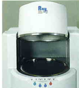
サンプルを切断せずに測定できる大型試料室
