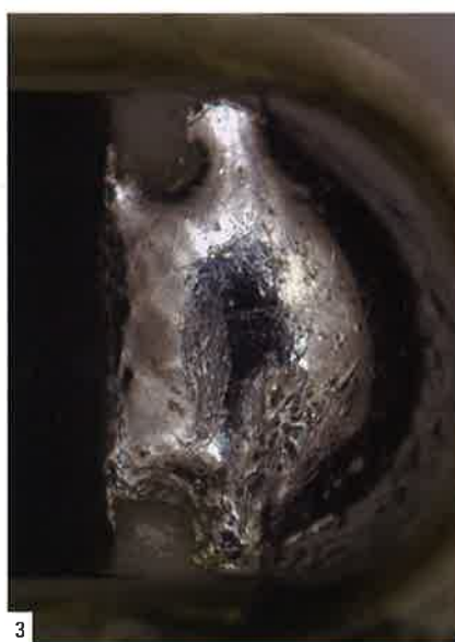
3: はんだ付け接点、175×、リングライト (拡散板付) 4: フィルタ格子、200×、透過照明 (バックライト)
