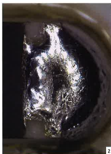
1: ウェハ、750×、同軸照明、レリーフコントラスト調整 2: はんだ付け接点、175×、リングライト
