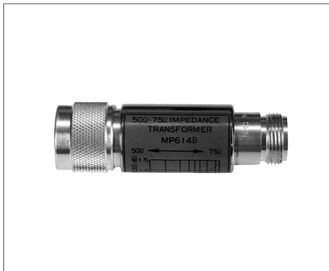
MP614Bは、50 ~ 1200 MHzの範囲で、主として信号発生器などの測定用信号源のインピーダンスを変える場合に用いられます。トランス型のため、抵抗減衰器型に比べて損失が少なく、信号源のレベルが実質的に低下するという欠点がありません。
