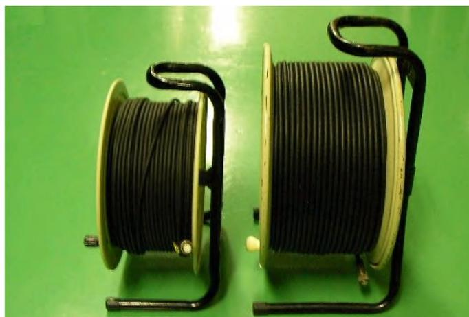
小さい方(ケーブル直径約5mm)・・・リール直径: 約28cm、幅: 約13cm、全高: 約33cm
