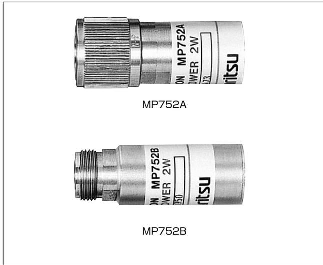
MP752A/Bは、DC~12.4 GHzの周波数範囲にわたってVSWRが優れており50 Ω同軸系に使用されるものです。コネクタはN型で、MP752A がプラグ、MP752Bがジャックです。
